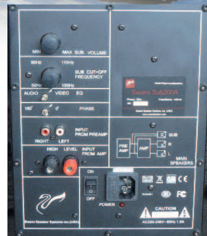
Schlicht und gut: Das Nötigste ist beim Subwoofer an Reglern und Schaltern vorhanden, beim Input reicht ein Sub-Cinch.
