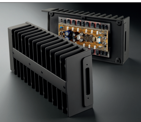
So geht Endstufenmodul: Die komplette Verstärkerschaltung eines Kanals ist direkt auf den jeweiligen Kühlkörper geschraubt
