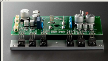
Eigene Stromversorgung für Signaleingangsstufe
